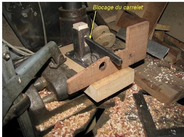
Les carrelets sont percés , , je mets un morceau de tube laiton dans chaque carrelet ( un tube récupéré sur un stylo manqué ) coupé en deux et non collé; cela permet si vous manquez le stylo, de n'avoir aucune perte. Vous pouvez mettre deux tubes neufs aussi sans les coller, mais il vous faudra couper les carrelets 1mm plus longs, cela pour faire l'entraînement bois contre entretoises de votre mandrins à stylos.
